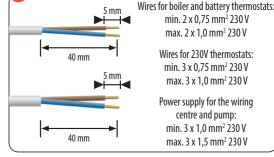
centre and pump: min. 3 x 1,0 mm<sup>2</sup> 230 V max. 3 x 1,5 mm<sup>2</sup> 230 V
